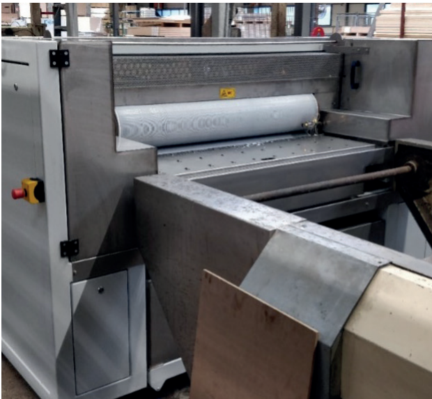
Glue spreader in bedrijf
